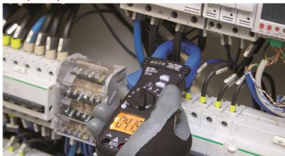
La sezione più ampia del toroide consente anche di abbracciare fasci di cavi in parallelo o sbarre di sezione fino a 26mm.
