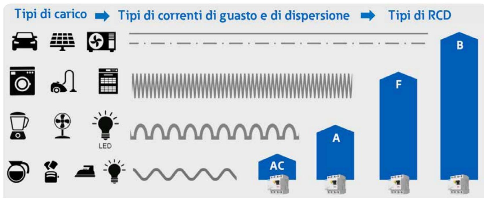
1) I differenziali B Eaton sono inoltre a controllo digitale dotati di LED frontali per la segnalazione della presenza di leakage current. Il tipo Bfq è inoltre dotato di una curva di intervento fino a 50kHz, quando la normativa arriva a richiedere 1kHz; il che lo rende particolarmente adatto alla protezione di circuiti con inverter trifase a variazione di velocità mediante modulazione di frequenza.
