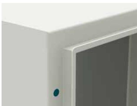
Piega strutturata dell'involucro con inclinazione 80° per una maggior rigidità strutturale e riduzione al minimo dell'eventuale danno alla guarnizione poliuretanic, con garanzia di maggior tenuta del grado di protezione IP (comprovato da test in-house e con Ente di certificazione)
