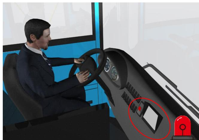
Il conducente può appurare quanti posti sono rimasti sul display e giudicare se fermarsi a caricare o proseguire
