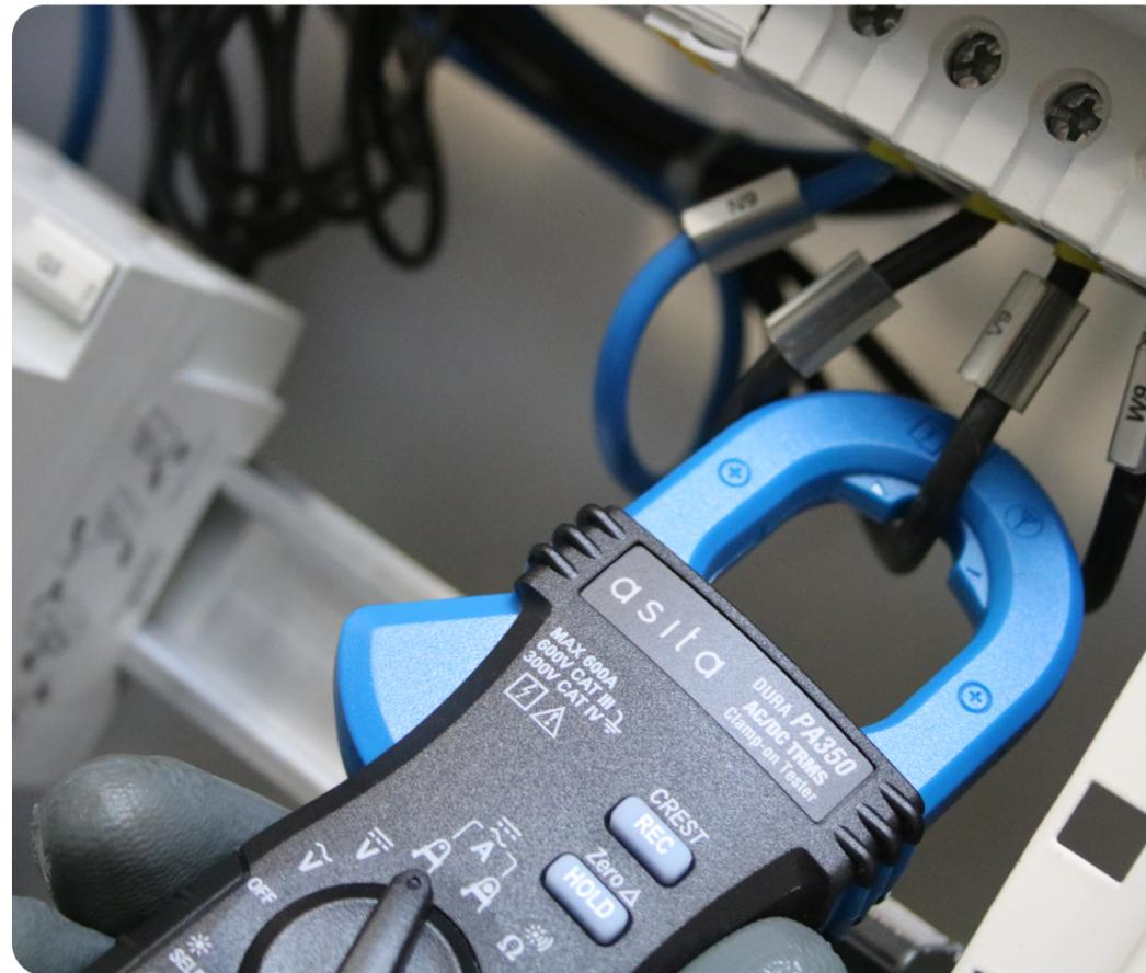
Le pinze amperometriche, oltre ad essere pratiche e semplici da usare, incorporano un innovativo sistema a doppio toroide che rende possibile misure precise posizionando cavi sottili (fino a 11mm) nell'apposito invito collocato nella punta. Lo strumento si adatta al modo di misurare del professionista!
