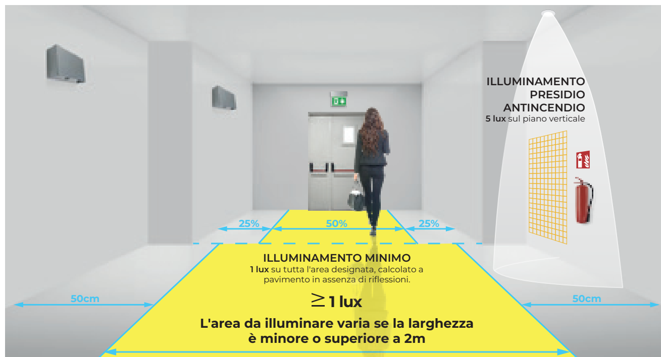
Fig. 2 – Illuminazione della via di esodo
