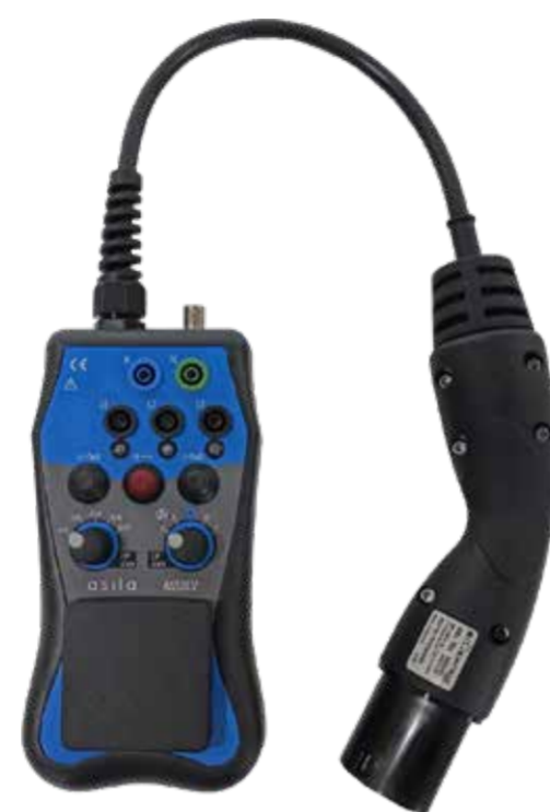
AS50EV Unità simulatrice del veicolo elettrico in carica.
