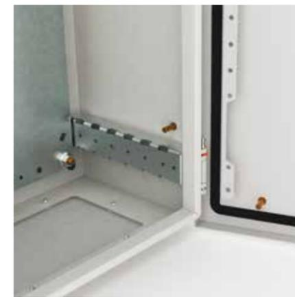
**Nuovo sistema funzionale di installazione accessori interni tramite squadrette universali e semplice fissaggio sotto le cerniere. Cablaggio semplificato grazie alla creazione di una struttura interna e regolazione in profondità a passo 25mm degli accessori grazie ai traversini universali**
