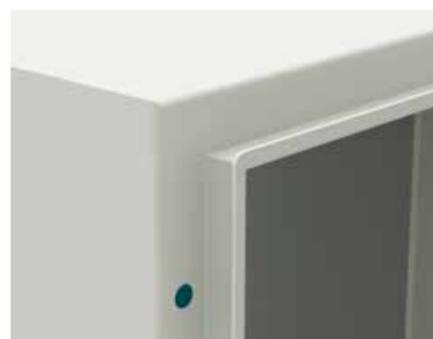
**Piega strutturata dell'involucro con inclinazione 80° per una maggior rigidità strutturale e riduzione al minimo dell'eventuale danno alla guarnizione poliuretana, con garanzia di maggior tenuta del grado di protezione IP (comprovato da test in-house e con Ente di certificazione)**
