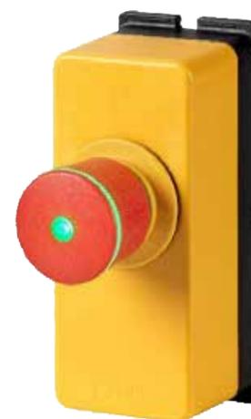
Eaton propone i propri pulsanti per arresto e interruzione di emergenza della serie Small E-Stop in custodia compatta. È possibile ordinare – utilizzando un unico codice – un pulsante Small E-Stop in custodia compatta in versione con sblocco "a ruotare" o "a tirare", eventualmente luminoso (con LED bicolore verde/rosso) e con due contatti che – a scelta – possono essere 2NC oppure INC+INA.
