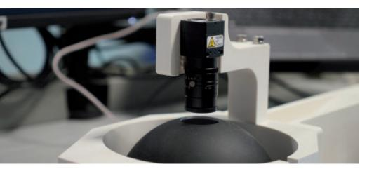
IMA Active, divisione di IMA Group dedicata alla produzione di sistemi e macchine automatiche per l'industria farmaceutica, ha recentemente aggiornato la sua soluzione per il rivestimento in continuo delle compresse grazie all'innesto di un sistema di visione OMRON dotato di videocamera a colori ad alta velocità e illuminatore "Dome". Il risultato è una valutazione molto accurata dell'uniformità del rivestimento, sia sulla superfice della singola compressa che tra le compresse.
