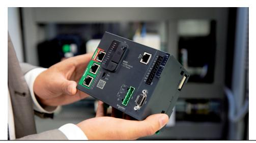
Onboard vi sono 8 I/O veloci, un ORCode che consente di identificare la macchina univocamente e di connettersi a risorse digitali per la manutenzione. Completano la dotazione del prodotto l'interruttore run/stop, il connettore per le espansioni I/O Modicon TM3 e lo smart communication bus per aggiungere i moduli di comunicazione Ethernet o Canopen, su tutte le versioni motion è presente un ingresso encoder incrementale o assoluto
